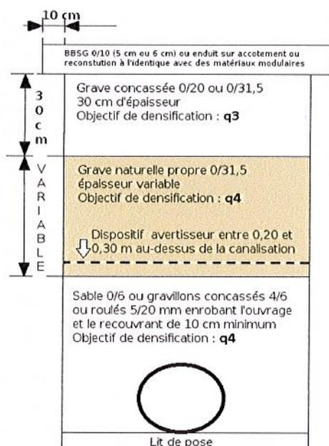
Si la tranchée ne peut être implantée à une distance au moins égale à sa profondeur (distance du bord de chaussée), la partie inférieure de remblai sera réalisée avec un compactage dont l'objectif de densification est q3 pour les 60 cm supérieurs de remblai.
