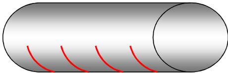
Diamètre des canalisations rigides : 100 mm avec fentes de 5 mm minimum, espacées tous les 0,1 à 0,15 m
